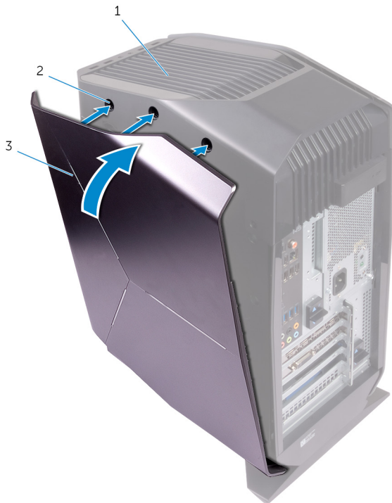
Rysunek 7. Instalowanie prawej pokrywy bocznej
