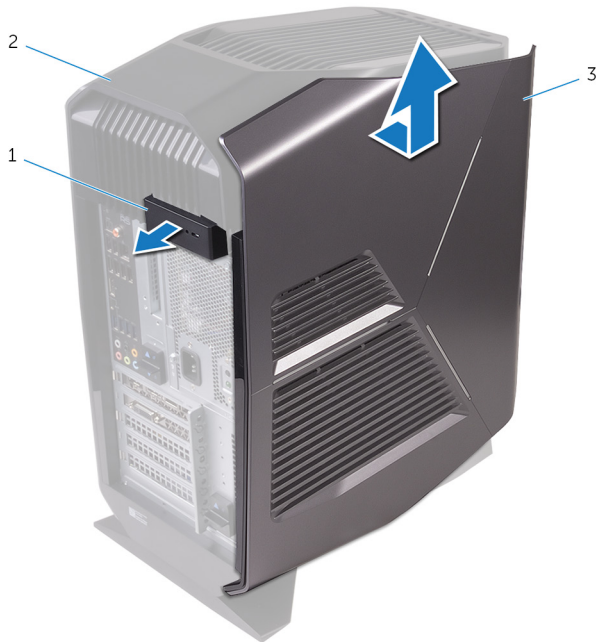
Rysunek 2. Wymontowywanie lewej pokrywy bocznej
