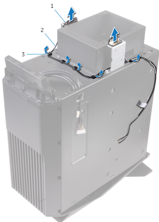
Rysunek 36. Wymontowywanie kabli antenowych
