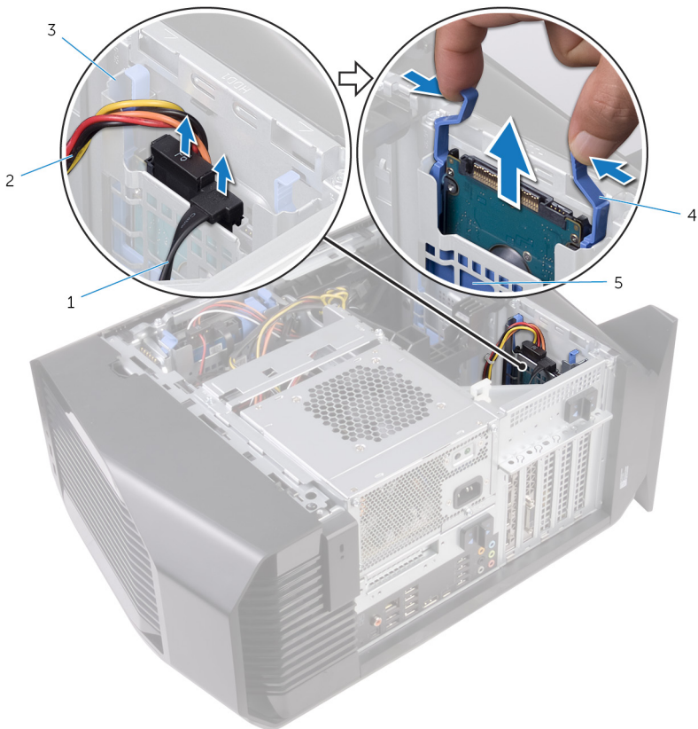
Rysunek 15. Wymontowywanie dysku twardego
