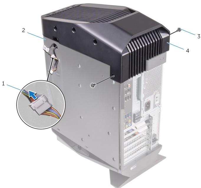
Rysunek 8. Wymontowywanie pokrywy górnej
