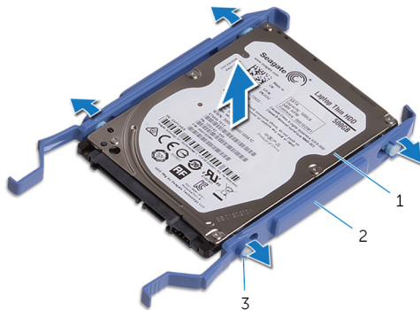
Rysunek 16. Wymontowywanie dysku twardego z oprawy
