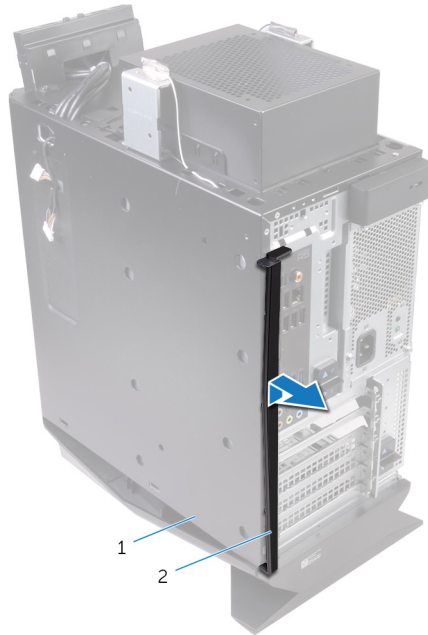
Rysunek 49. Wymontowywanie tylnego profilu osłonowego
