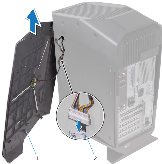
Rysunek 5. Wymontowywanie prawej pokrywy bocznej
