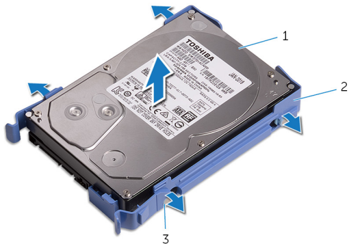
Rysunek 14. Wyjmowanie dysku twardego ze wspornika
